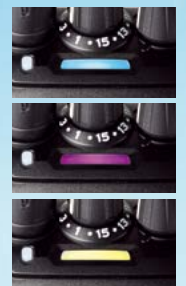
Indicatore visivo con 7 tonalità di colore: Ad ogni canale può essere assegnato un colore diverso tra i sette disponibili.
