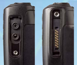
Modelli con connettore a 2 poli (a sinistra) e connettore universale a 14 poli (a destra)
